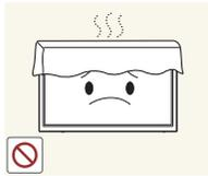
Stellen Sie sicher, dass die Lüftungsöffnungen nicht durch Tischdecken oder Vorhänge blockiert sind.
