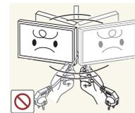
Heben oder bewegen Sie das Gerät nicht, indem Sie am Netzkabel oder an einem anderen Kabel ziehen.
