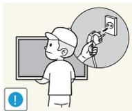
Schalten Sie vor dem Transport des Geräts den Netzschalter aus, und ziehen Sie das Netzkabel und alle anderen angeschlossenen Kabel ab.
