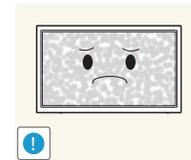
Das Anzeigen von Standbildern auf dem Bildschirm über einen längeren Zeitraum kann zum Einbrennen von Nachbildern oder Pixelfehlern führen.
