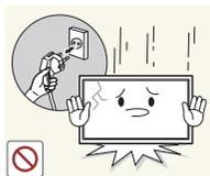
Wenn das Gerät heruntergefallen oder die Verkleidung beschädigt ist, schalten Sie den Netzschalter aus, und ziehen Sie das Netzkabel ab. Wenden Sie sich dann an das Samsung Kundenservicecenter.
