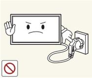
Ziehen Sie das Netzkabel nicht ab, während das Gerät verwendet wird.
