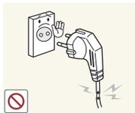
Verwenden Sie kein(en) beschädigtes/n Netzkabel oder Stecker oder eine lose Steckdose.
